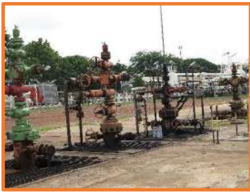
✓ มีการติดตั้งวาล์วฉุกเฉินระดับพื้นผิว (Shutdown valve)
